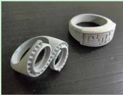
3次元成型機で試作したモデル
